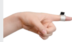
振動計測フィルムセンサ ゆびレコーダー 指で感じた振動をキャッチ
