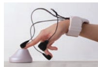
接触力センサ HapLog 指の押付力を計測
