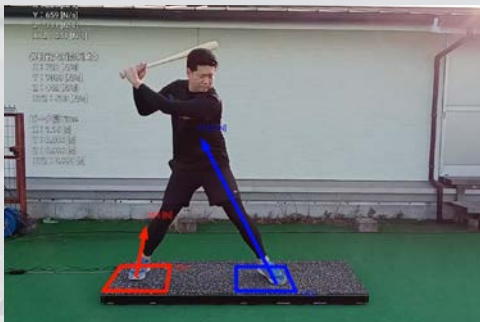
バッターボックスの フォースプレートは 3段階で位置調整可能
