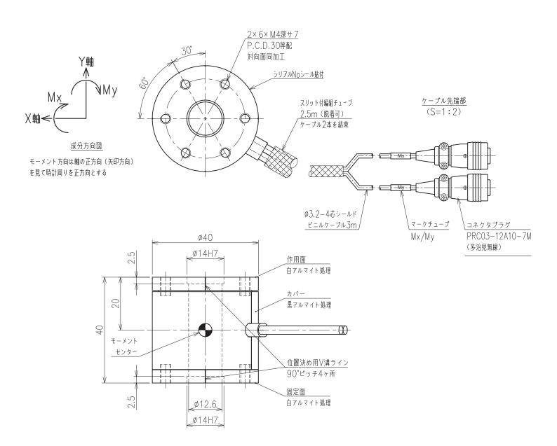
注1. 作用面および固定面のM4ネジ穴に使用するボルトは、 先端が有効ネジ深サ以下になる長さを選定ください
