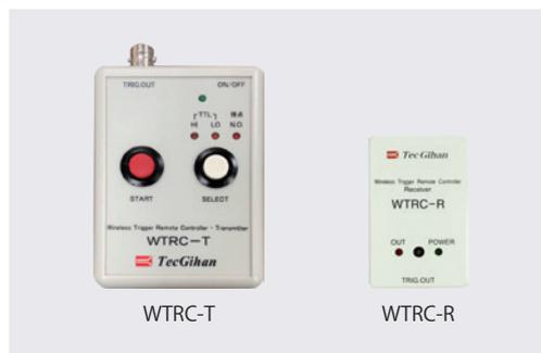
PDL-06-SA と外部機器の記録タイミングを合わせるための TRIG 発信機です。ボタン押下と同時に赤外線 TRIG、接点信号または TTL 信号を発信します。WTRC-R では赤外線を感知すると同時に接点信号を出力することができます。
